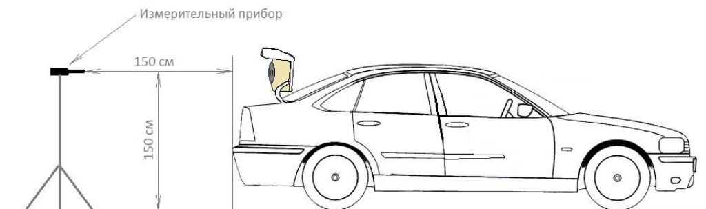
Рисунок 3. Расположение измерительного оборудования во время замеров классов «Тыл».
